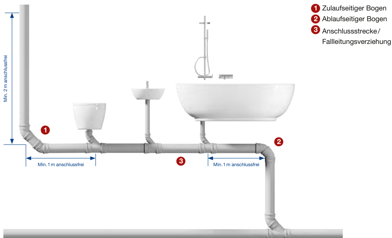
Abb. 8: Falleitungsverziehung > 2 m und anschlussfreie Leitungsbereiche
