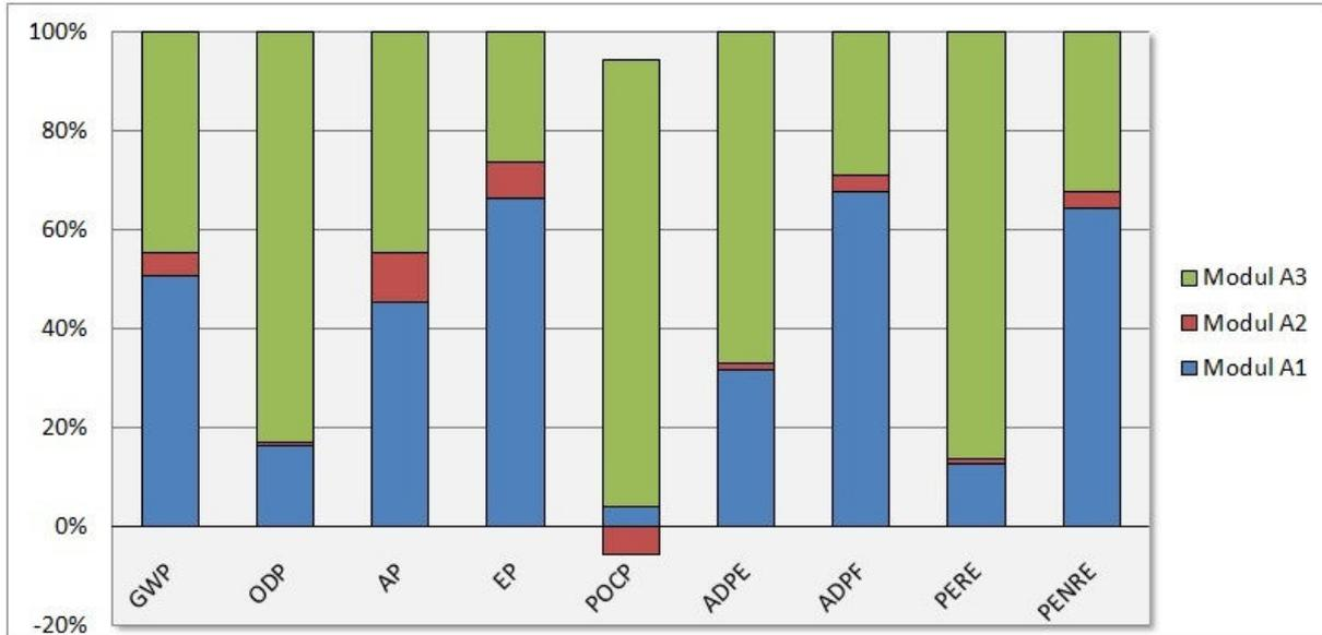
Abb. 1: Relative Anteile der Module A1-A3 am Einfluss auf die Umweltwirkungsindikatoren und den Primärenergieeinsatz (cradle-to-gate)
