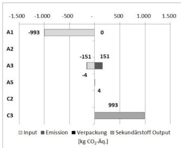
Abb. 2: Holzinhärente CO<sub>2</sub>-Produktsystemein- und -ausgänge [kg CO<sub>2</sub>-Äq.]. Die inverse Vorzeichengebung der In- und Outputs trägt der ökobilanziellen CO<sub>2</sub>-Flussbetrachtung aus Sicht der Atmosphäre Rechnung.
