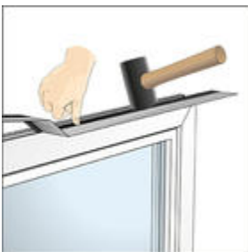
Bild 14: Geeignete Kederfolie in die äußeren Blendrahmen-Nuten einbringen
