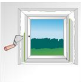
Bild 13: Einputzen und glattstreichen
