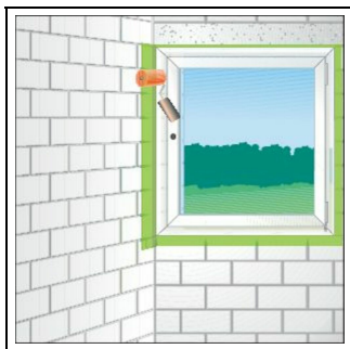
5. Bild: Folie mit einem Andruckroller anrollen
